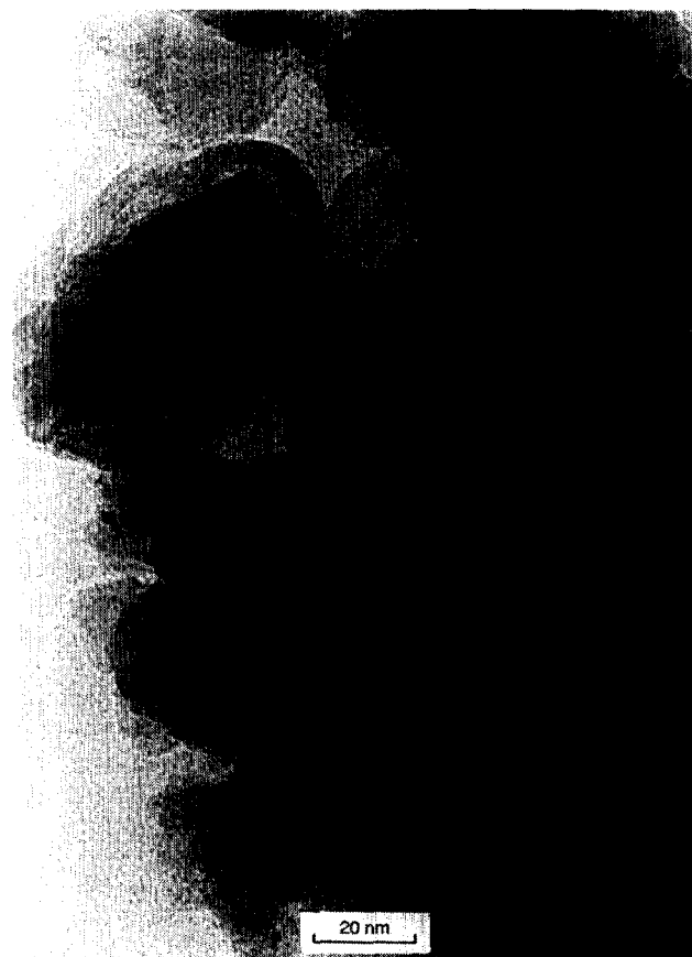
Fig 12. Agrégat de diamants (MET) obtenu par compression par choc d'un mélange de noir de carbone N110 et de cuivre (échantillon n° 1).
